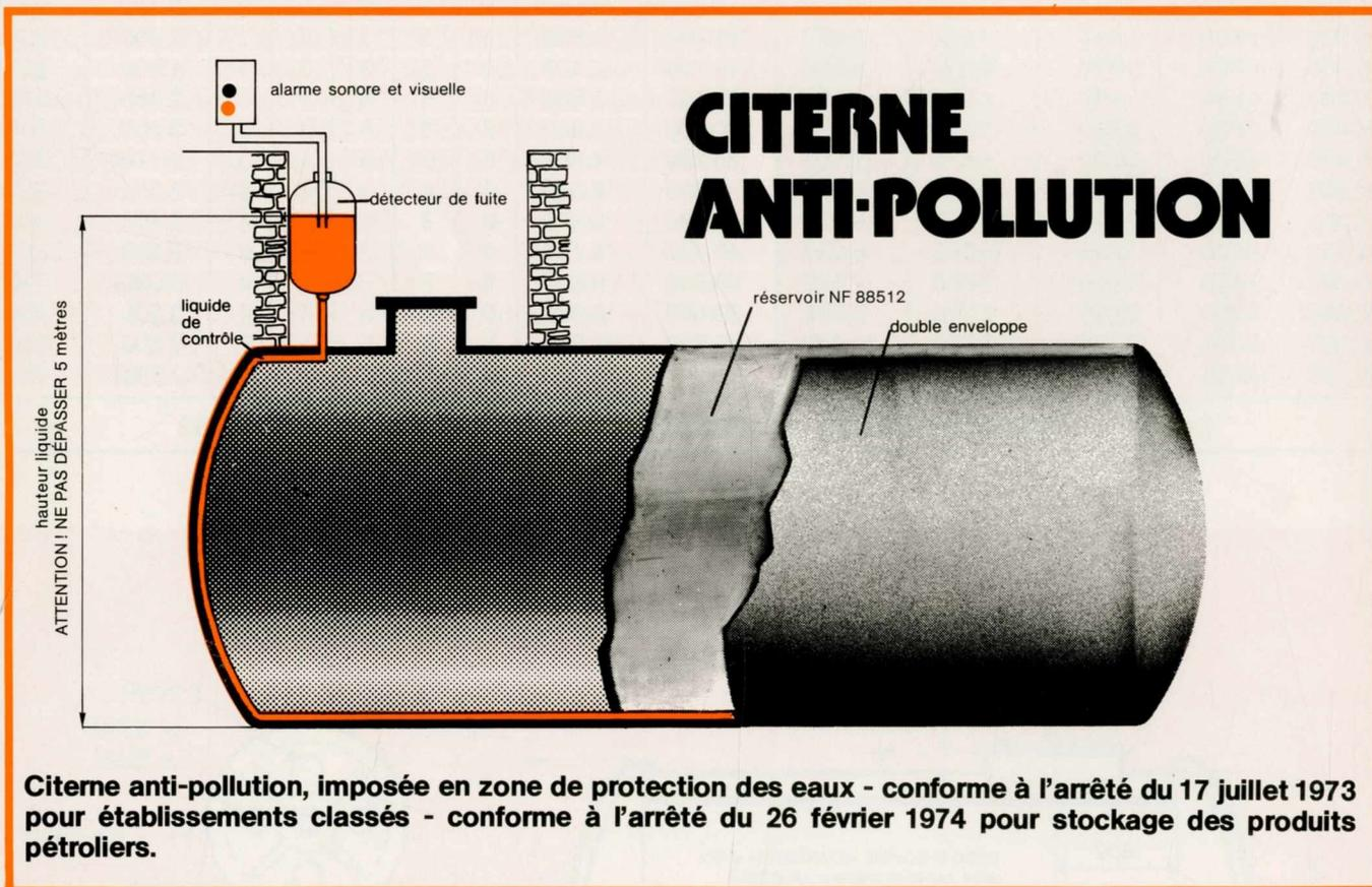
**Citerne anti-pollution, imposée en zone de protection des eaux - conforme à l'arrêté du 17 juillet 1973 pour établissements classés - conforme à l'arrêté du 26 février 1974 pour stockage des produits pétroliers.**
