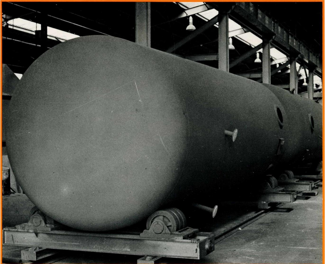
Chaîne de fabrication des réservoirs sous pression.
